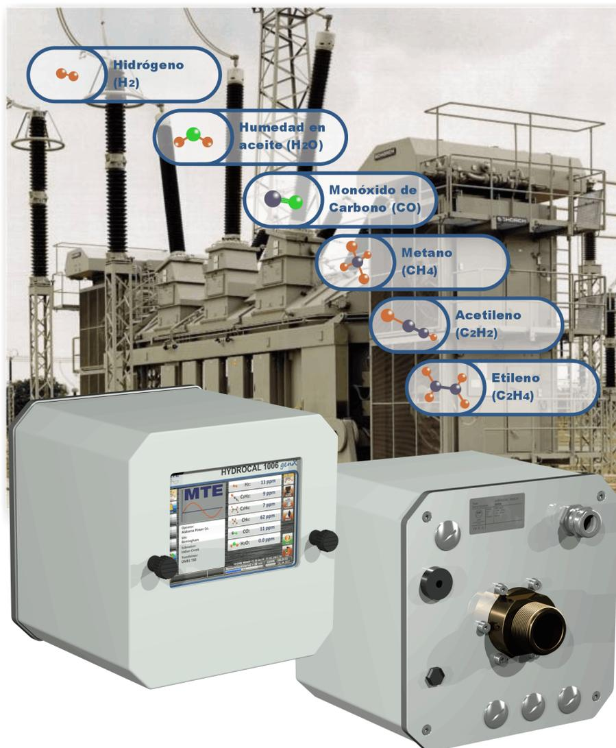
El nuevo HYDROCAL 1006 *genX* es la primera solución DGA online multi-gas verdaderamente libre de mantenimiento que combina la probada tecnología de medición "near infrared" (NIR) con extracción por membrana protegida al vacío.
